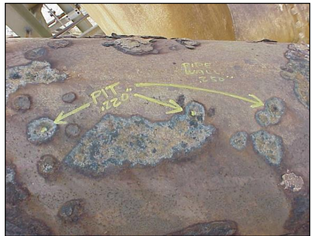
Fig. 2 – La preparación de la superficie que se muestra a mano izquierda es generalmente inaceptable. En los casos en que la tubería no se puede limpiar adecuadamente, hay que señalar que las propiedades finales del sistema compuesto pueden verse comprometidas (tales como una adherencia inferior a la superficie de acero).
