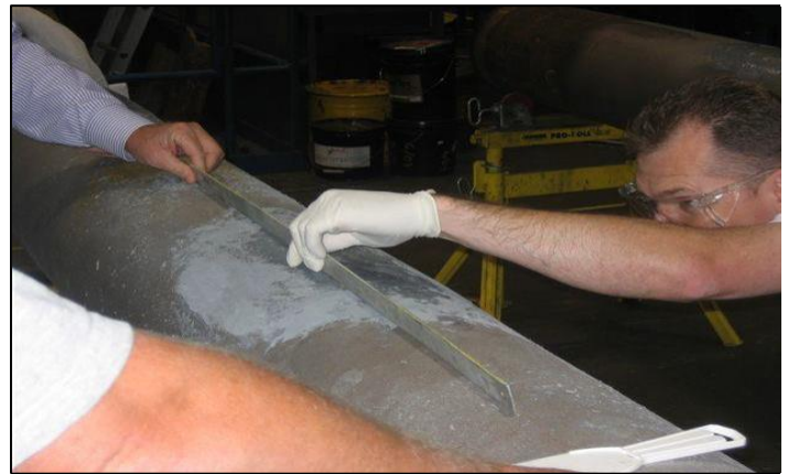
Fig. 5 –Use una regla para confirmar la uniformidad de la masilla de relleno
